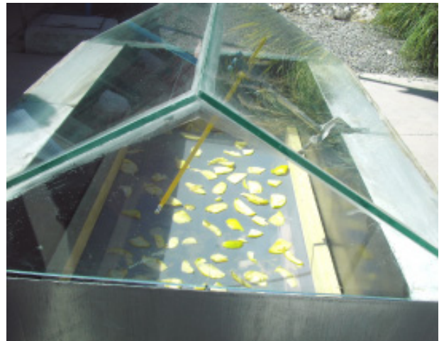
El deshidratador en operación, en este diseño, se colocó un total de 4 Kg. de manzana, la cual se logra deshidratar después de 8 horas de operación.
