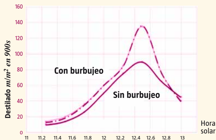
Figura 6: Producción de destilado, ml/m 2 en intervalos de 900s, para una prueba típica en marzo. La curva superior describe los resultados del destilador intensificado.
