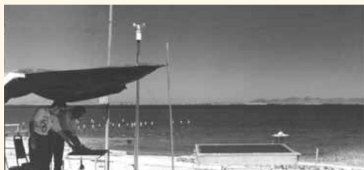
Fig 3. Configuración al aire libre típica para monitorear el funcionamiento de la cámara solar superficial (cámara mirando hacia el norte).
