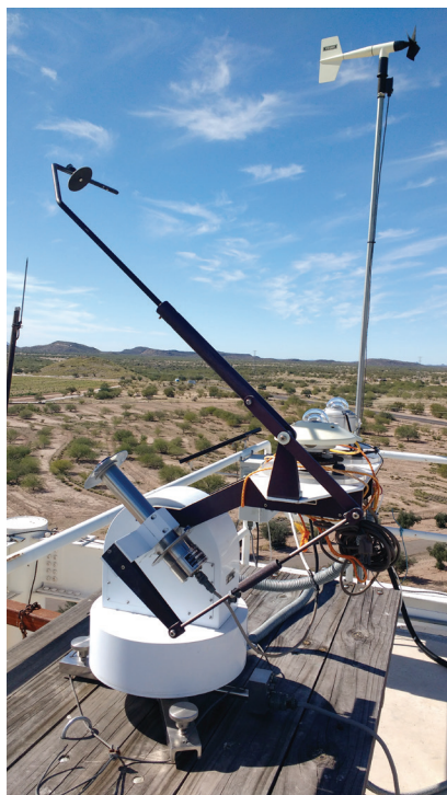
Figura 1.10. Estación solarimétrica automatizada.
