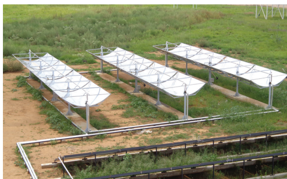
Figura 2.4.10. Captadores solares a concentración de canal parabólico. (Planta Experimental de Secado Solar en Zacatecas).
